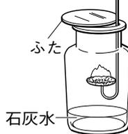
[実験2] [実験1]で燃えた物質は, 図2のように石灰水の入った集気びんに入れる。火が消えたら燃焼さじを取り出して集気びんをよくふり, 石灰水の変化を調べる。
