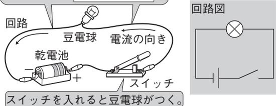
●電流が流れるようにした道筋が  である。
