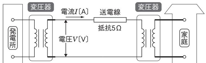
1000W を変圧器で、ある電圧 [V] にして送り出したとして、次の問いに答えなさい。ただし、変圧器での電力損失はないものとする。
